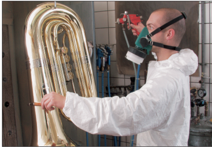
Das Aufbringen einer gleichmäßigen Lackschicht von Hand im staubfreien Raum ist für die gewünschte Qualität eine unerlässliche Voraussetzung
